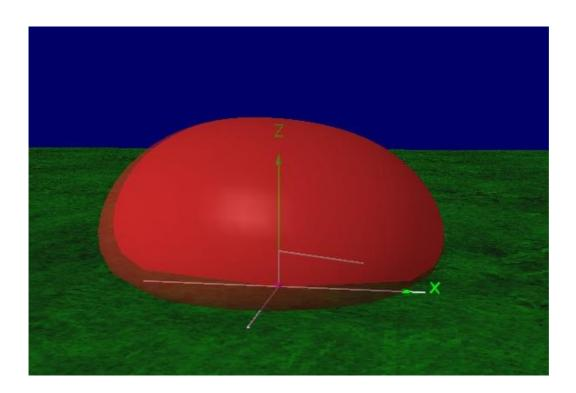
Per una rappresentazione più efficace ho poi calcolato l'emissione in termini di potenza ERP. La potenza emessa dal TX è stata imposta a 500W e con una attenuazione totale di 0,8 dB, la potenza all'alimentazione dell'antenna è di 416W. Tale potenza è poi irradiata in base alla caratteristica di guadagno (positivo o negativo) dell'antenna medesima.
