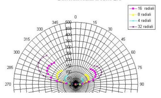
Dal grafico si può notare come la potenza ERP per un angolo di 30° passi da circa 100W per l'antenna con minore guadagno (4 radiali) a quasi 350W con l'antenna a guadagno più elevato (32 radiali). In altri termini, con una antenna con 4 radiali, per ottenere la stessa potenza ERP di una antenna con 32 radiali trasmettendo con una antenna a 4 radiali sarebbe necessario aumentare la potenza a oltre 1700W.
