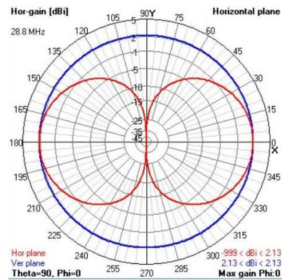
A sinistra abbiamo il lobo di radiazione relativo ad un dipolo orizzontale,  $G=2.13\text{dBi}$  *free-space*, in rosso i valori della componente sul **piano azimutale** ed in blu quelli relativi al **piano zenitale**; a destra abbiamo identica rappresentazione relativa ad un dipolo verticale. Si nota subito che mentre nel primo i valori per le componenti zenitali *sopra la testa del dipolo e sotto i suoi piedi* sono diversi da zero, nel secondo essi sono prossimi a zero.
