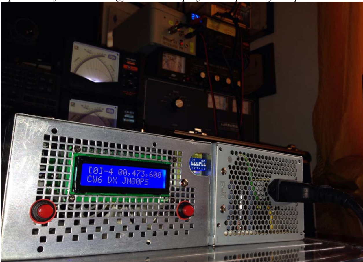
Il primo kit nella versione finale con modifiche varie e scheda di espansione PTT e commutazione antenne. Trasmissione in QRSS6 a 473,600 Khz con Pa comandato dal circuito ad opto-isolatore.
